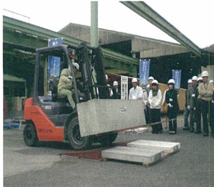
パルコン板の強さの実験
